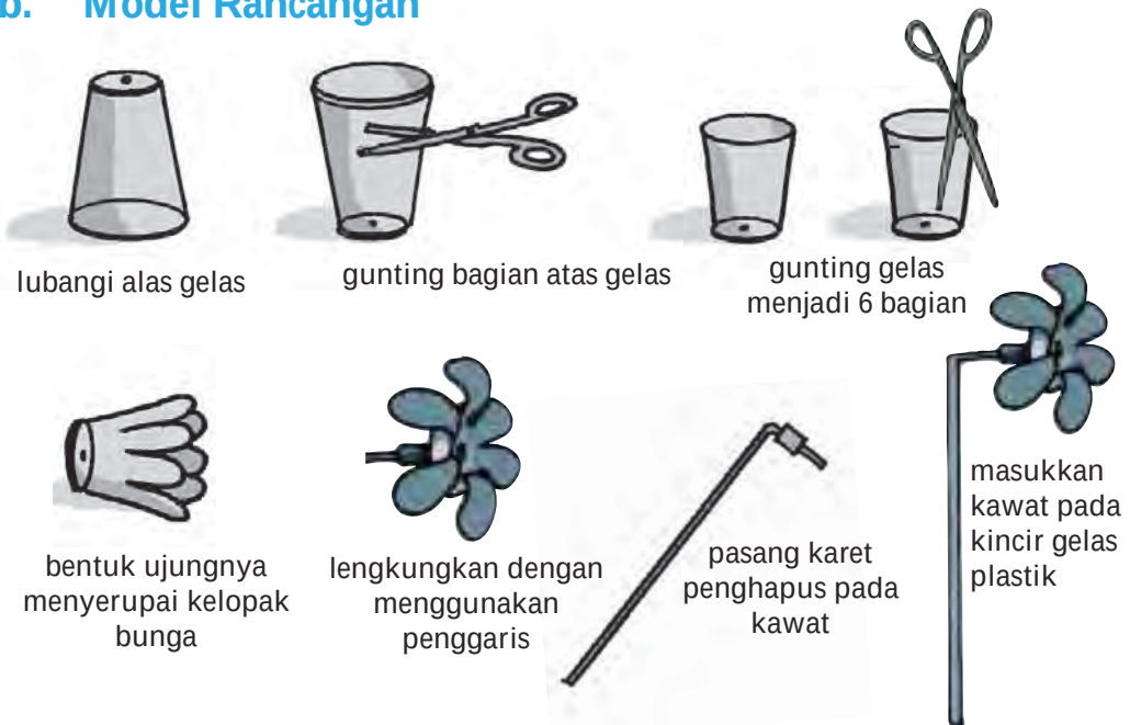
Gambar 6.22 Model pembuatan kincir angin dari gelas plastik
