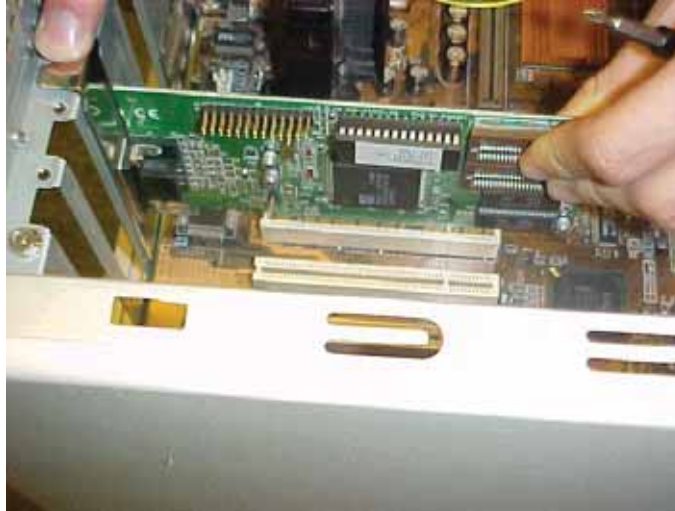
Gambar 3.15. Pemasangan expansion card.
