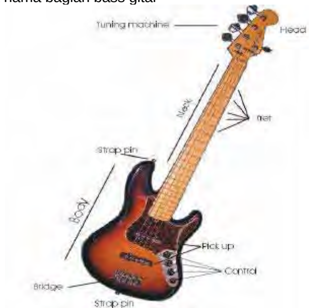
Gambar 2 : bass elektrik dan bagiannya
