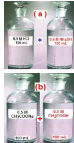
Gambar 8.26. Skema pembuatan larutan buffer (a) jumlah basa lemah berlebih, (b) garam ditambahkan dengan asam lemahnya
