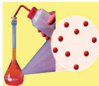
Gambar 8.1. Cara membuat larutan, 1 gram kalium bicromat ditambahkan 100 mL air dalam labu ukur
