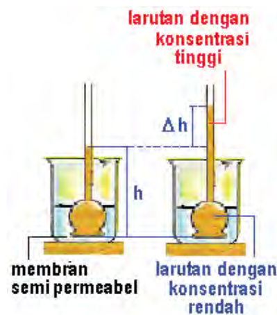
Gambar 11.7. Percobaan perembesan larutan melalui membran semi permeabel
