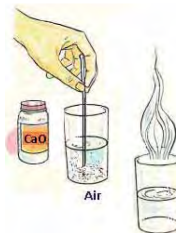
Gambar 10.14, Reaksi kimia yang menghasilkan energi seperti \text{CaO} + \text{H}_2\text{O} \rightarrow \text{Ca(OH)}_2 + \text{panas}
