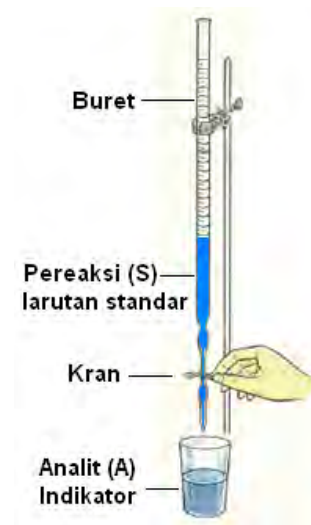
Ambar 15.14. Alat dan cara melakukan titrasi
