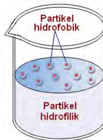
Gambar 15.3. Prinsip pemisahan dengan cara flotasi
