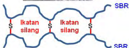
Gambar 13.17. Karet sintetik dan vulkanisasi untuk ban kendaraan bermotor
