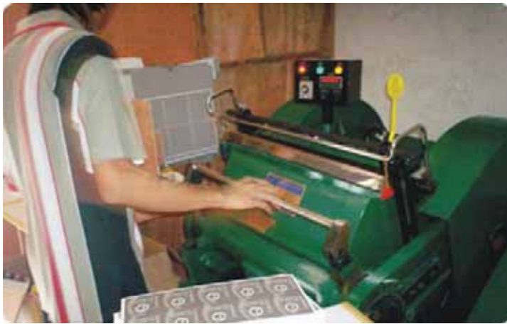
Gambar 10.2. Operator melakukan pengeponan dengan mesin
