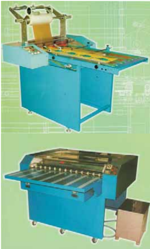
Gambar 9.2. Mesin laminasi sistem panas ( thermal ) buatan PAMOR – Behe Machinery Workshop
