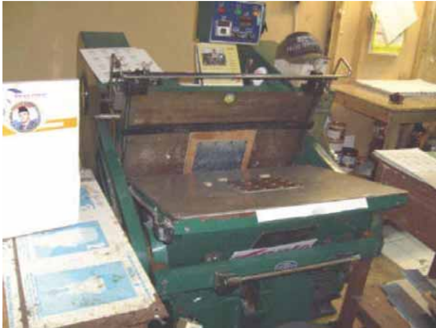
Gambar 10.8. Pengembossan dapat dilakukan dengan mesin degel
