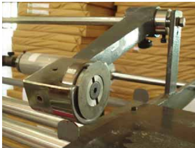
Gambar 9.7.. Tangkai/ batang pisau pemotong/ perforator
