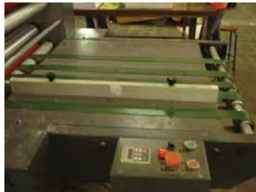
Gambar 9.4. Unit Pemasukan (meja aparat dan tombol operasi)
