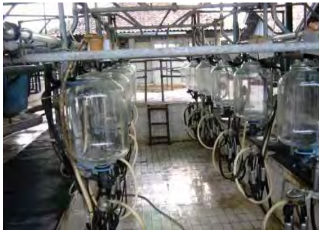
Gambar 19. Mesin Perah Tipe Herringbone dengan Tabung Individu.
