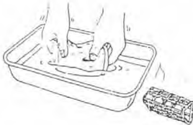
Gambar 5.17: cara mencuci saringan udara
