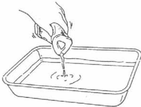
Gambar 5.18: cara memeras saringan udara
