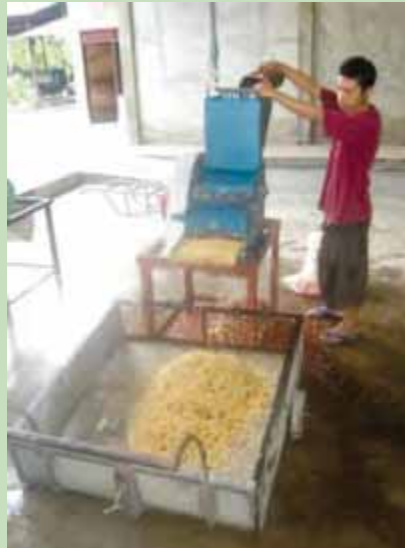
Gambar 6 Alat Pengupas Kulit Buah Kopi
