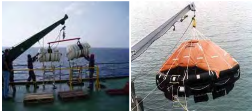
Gambar 68. Jenis rakit penolong yang diturunkan menggunakan davit
