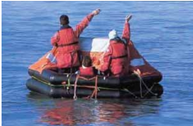
Gambar 67. Rakit penolong setelah dikembangkan di laut
