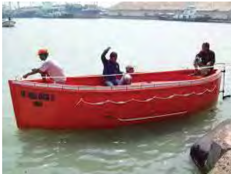
Gambar 59. Sekoci penolong bermotor
