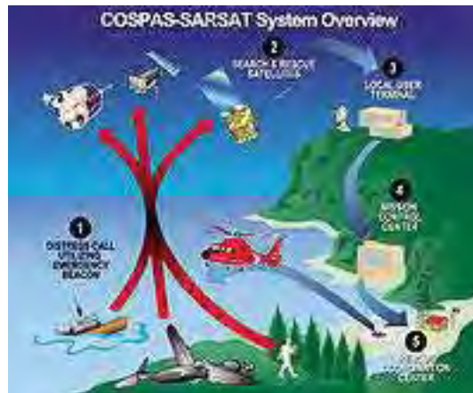
Gambar 91. Sistem kerja EPIRB
