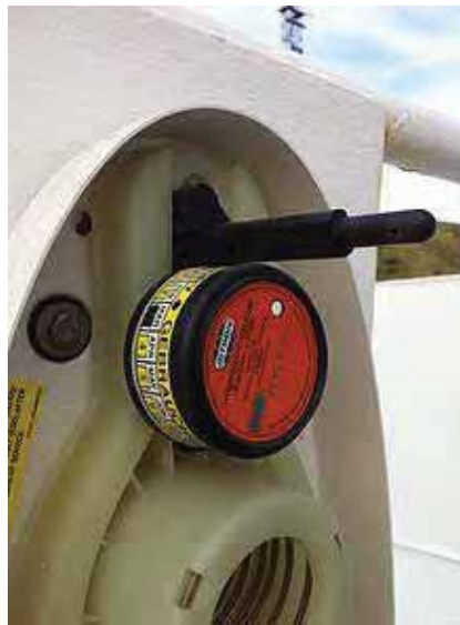
Gambar 92. Hydrostatic Release System pada EPIRB
