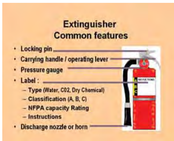
Gambar 110. Bagian-bagian umum APAR
