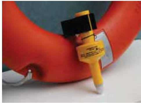
Gambar 40. Pelampung penolong dilengkapi dengan lampu
