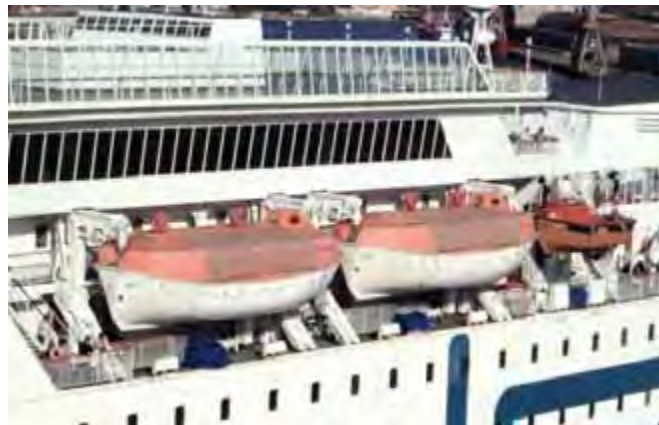
Gambar 53. Penempatan sekoci penolong di kapal
