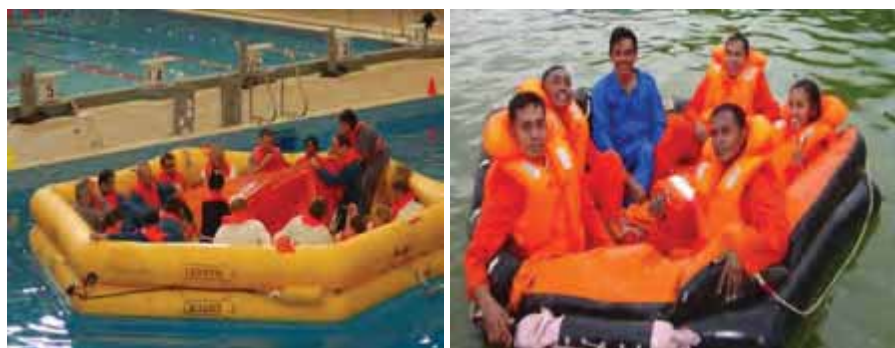
Gambar 65. Rakit penolong yang dapat dikembangkan
