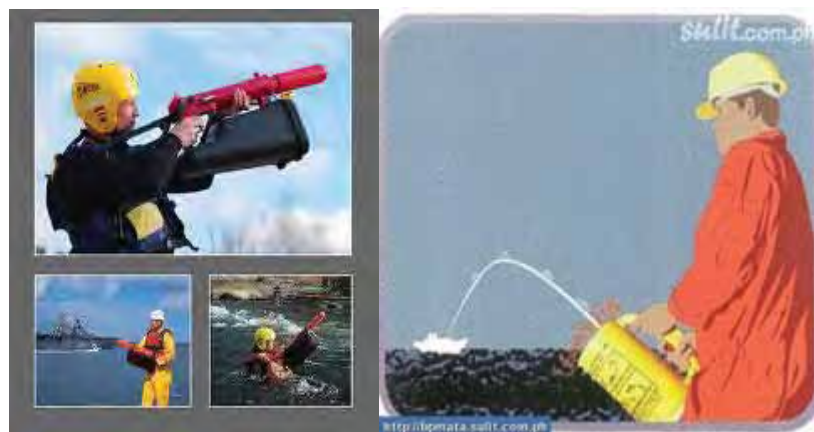
Gambar 89. Line throwing appliances digunakan untuk meluncurkan tali
