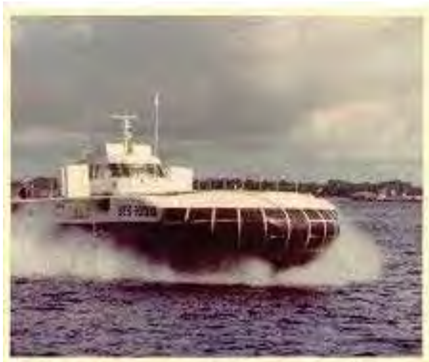
Gambar 2.17 Kapal CAB ( capture air bubble ) beroperasi pada air yang relatif tenang.
