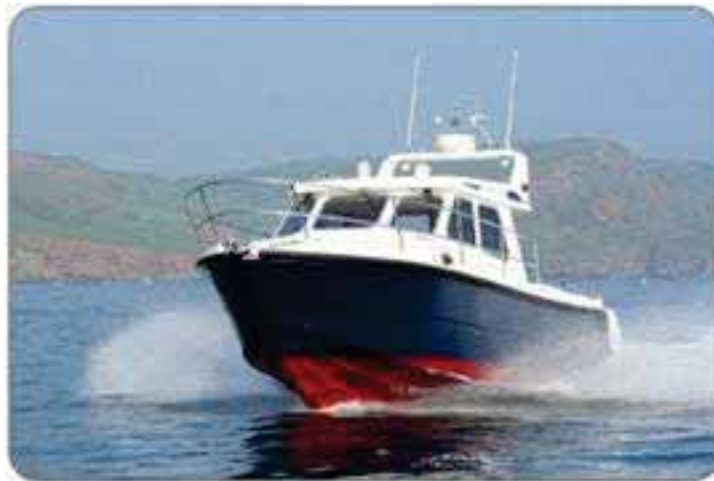
Gambar 2.18 Kapal planing hull , bagian depan kapal terangkat ketika melaju pada kecepatan tinggi.
