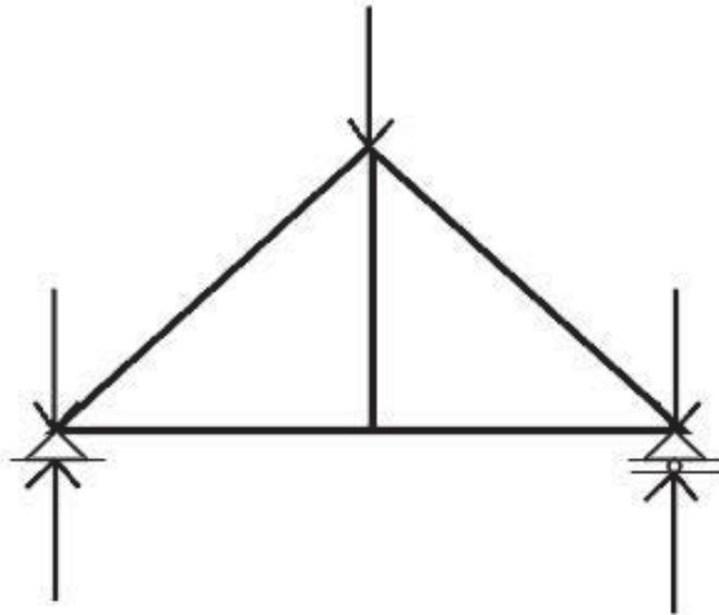
Gambar 89. Konstruksi Rangka Batang Statis Tertentu
