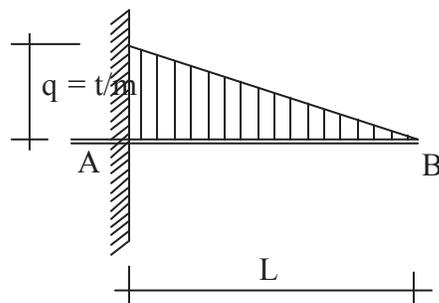
Untuk menghitung reaksi tumpuan maka muatan terbagi tidak merata sepanjang  $l$  diganti dengan sebuah muatan terpusat  $Q$ . Besar  $Q=1/2 q.l$ .
