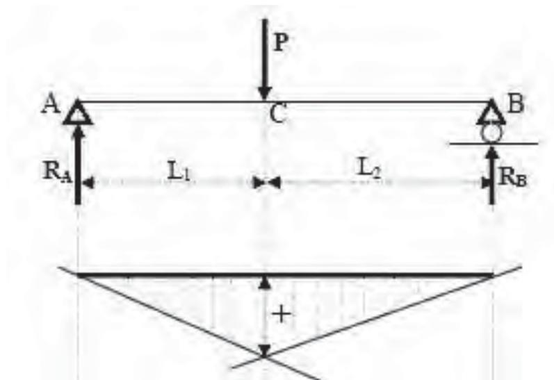
Gambar 96. Penggambaran *bending moment diagram* (BMD) dengan cara grafis.
