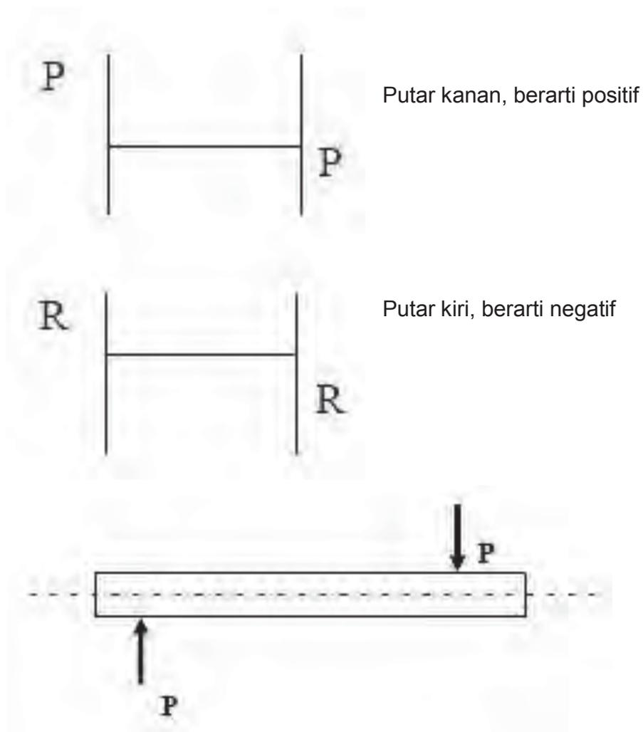
Gambar 94. Konsep SFD pada struktur balok
