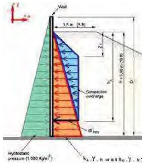
Gambar 74. Tekanan aktif tanah dan beban hidrostatik
