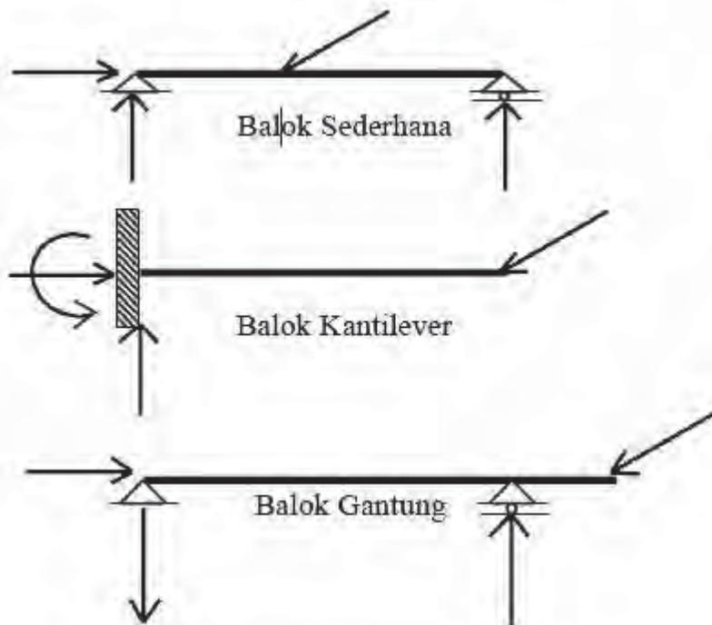
Gambar 87. Balok-Balok Statis Tertentu
