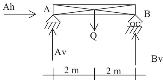
Untuk menghitung reaksi tumpuan muatan merata diganti dengan sebuah muatan terpusat.
