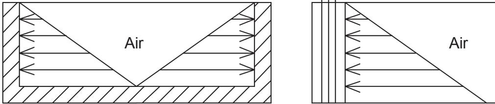
Tekanan air pada dinding bak atau pada pintu air tidak terbagi rata (merupakan tekanan segitiga) yang dimulai dari bagian atas kecil tak terhitung dan semakin ke bawah semakin besar.
