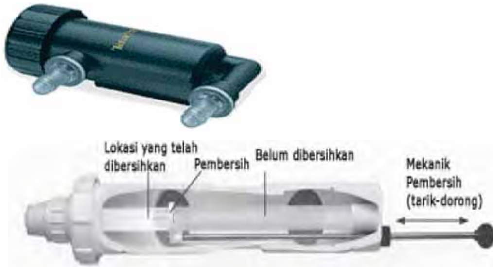
Gambar 8. UV sterilizer yang dilengkapi dengan mekanisme pembersih
