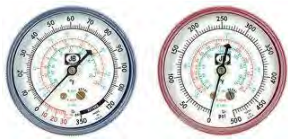
Gambar1. 8 Skala pada Compound dan Pressure Gauge
