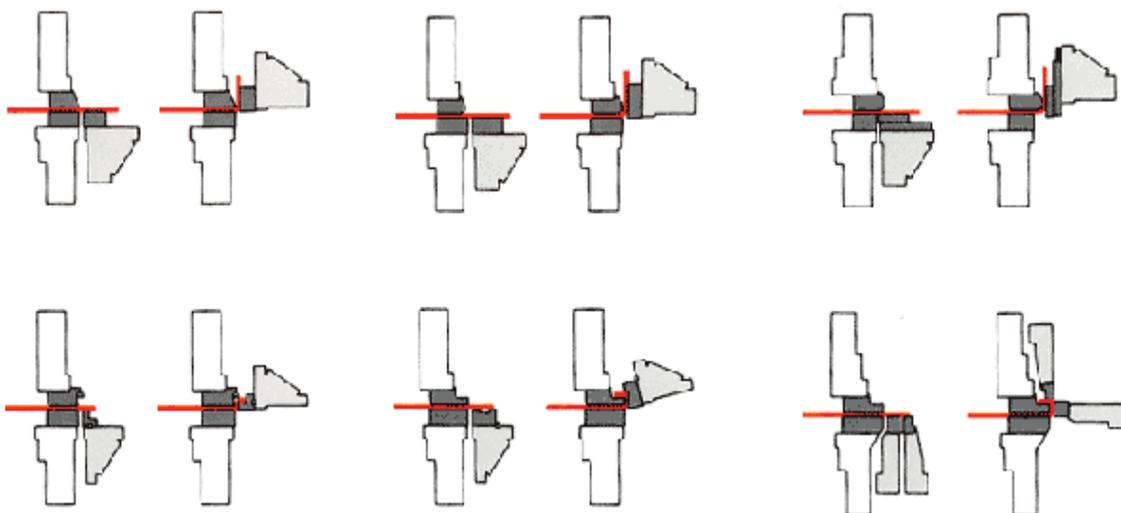
Gbr. 3.12 : Proses bending dengan mesin folding
