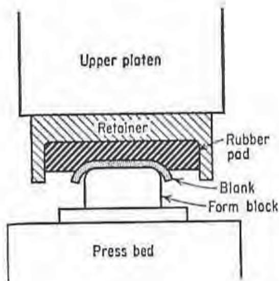
Gbr. 4.4 : Proses pembuatan part dengan mesin press
