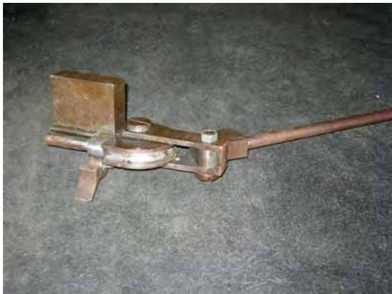
Gbr. 4. 10 : Alat pembengkok pipa alumunium
