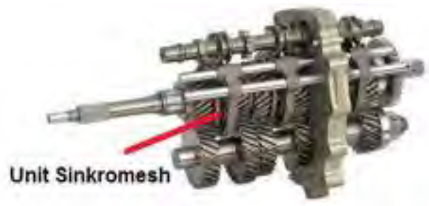
Gambar 4.29. Transmisi dengan sinkromesh
