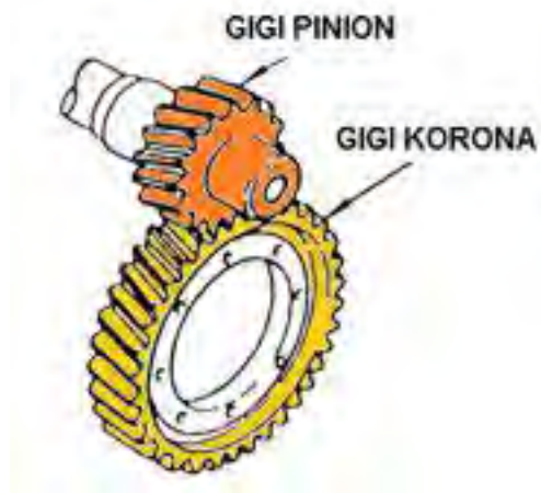
Gambar 4.59. Penggerak roda helical (Helical Gear)
