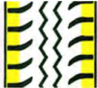
Gambar 7.7. Tapak ban bentuk RIB-LUG
