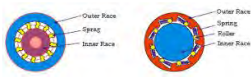
Gambar 4.11. Kopling satu arah tipe sprag dan tipe roller
