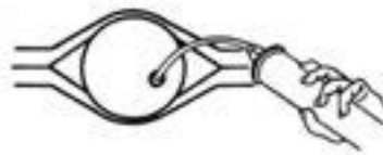
Gambar 4.68. Pengisian Oli pada Penggerak Aksel
