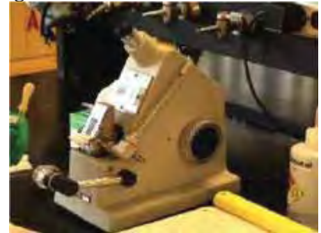
18. Setelah membersihkan, sisipkan tissu bersih di antara dua prisma dan jangan lupa mematikan lampu
