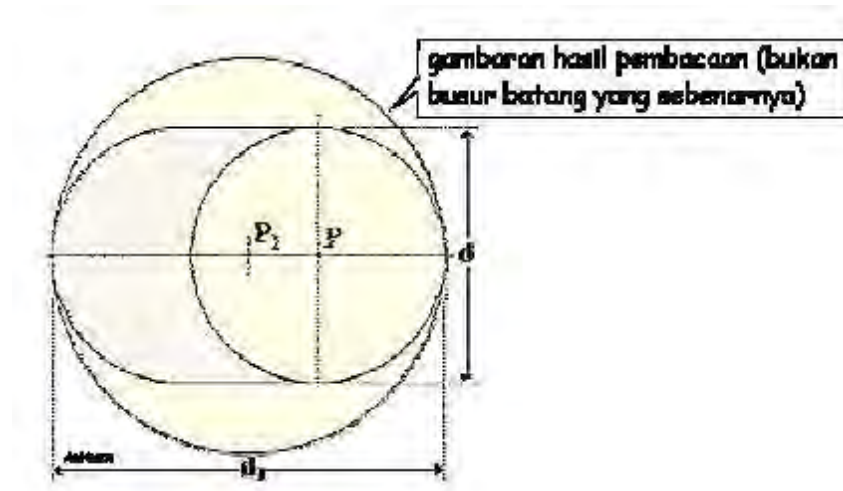
Gambar 34. Kesalahan ukur dengan diameter Sumber : Asy'ari dkk. (2012)
