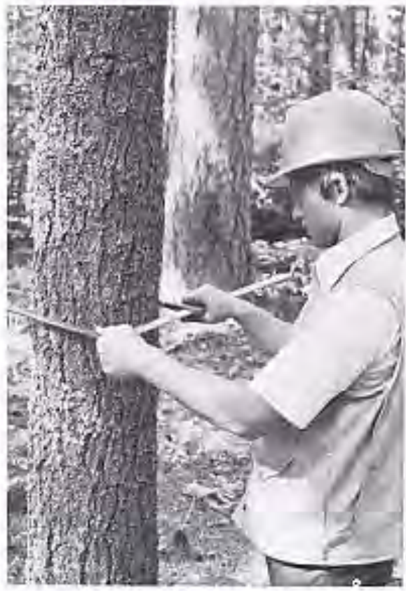
Gambar 35. Pengukuran diameter pohon menggunakan kaliper Sumber : Lorimer (1982)
