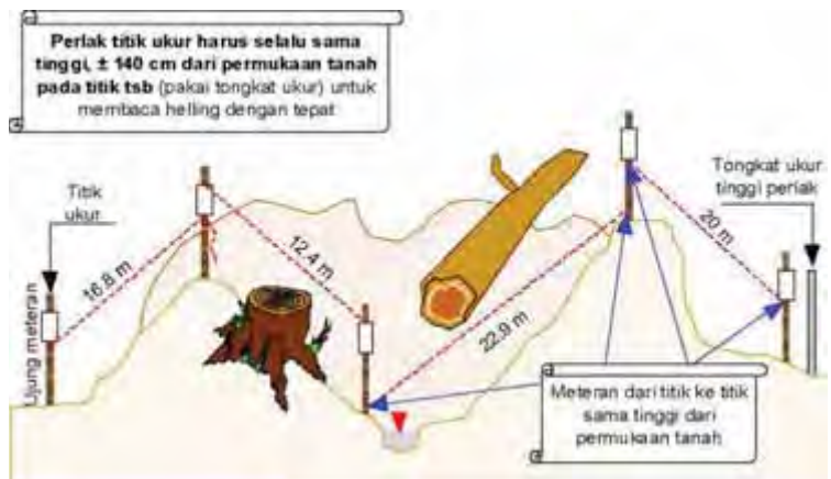
Gambar 9. Pengukuran jarak lapangan (Jaya,2011)
