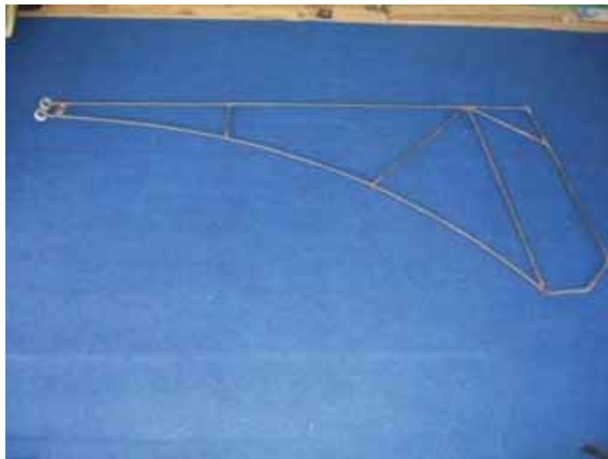
Gambar 81. Mal cetakan kubah
