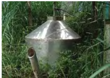
Gambar 31.Reaktor biogas dari lembaran baja
