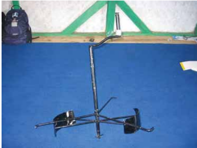
Gambar 123. Mixer untuk mengaduk pada pipa inlet
