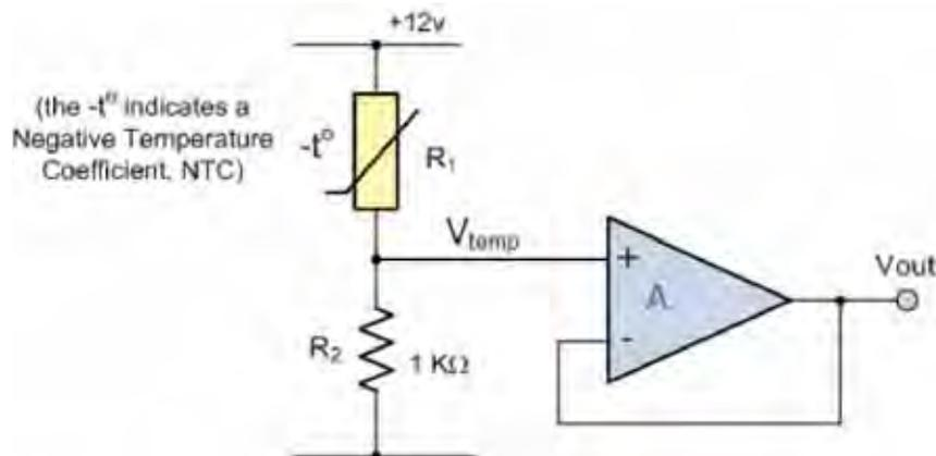
Gambar 2.10 Rangkaian Penguatan Thermistor
