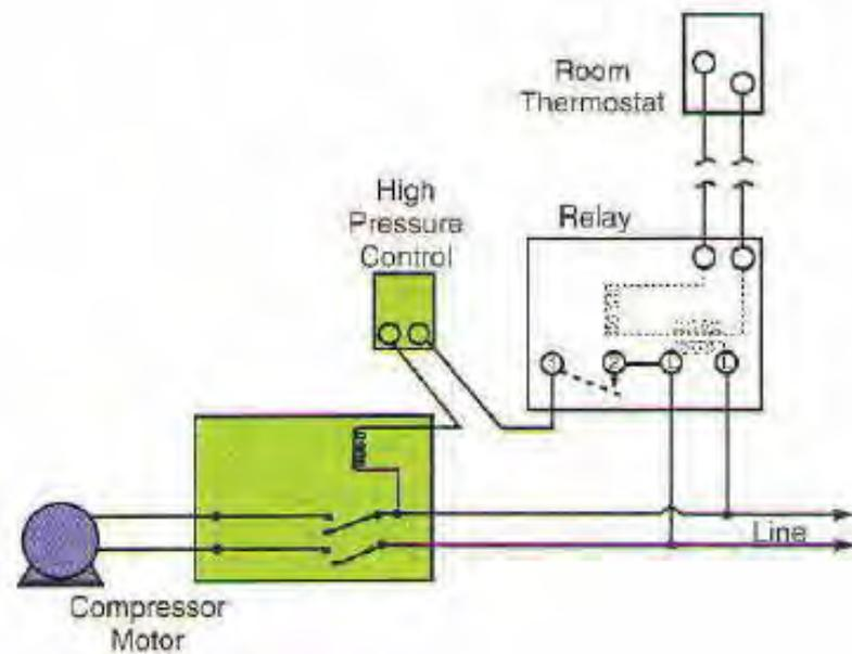
Gambar 4.7 Rangkaian Kontrol Motor Kompresor dengan Thermostat
