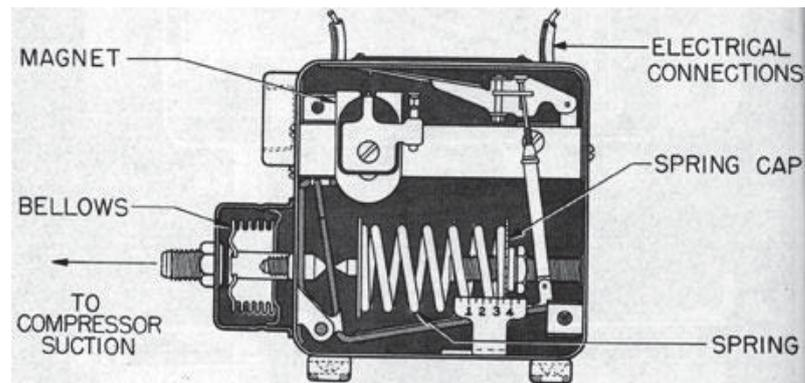
Gambar 4.14 Konstruksi Low Pressure Switch dengan Bellow
