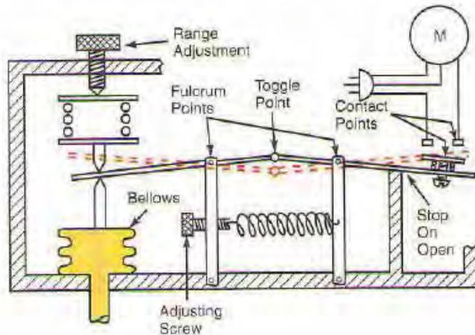
Gambar 2.3 Mekanisme Toggle
