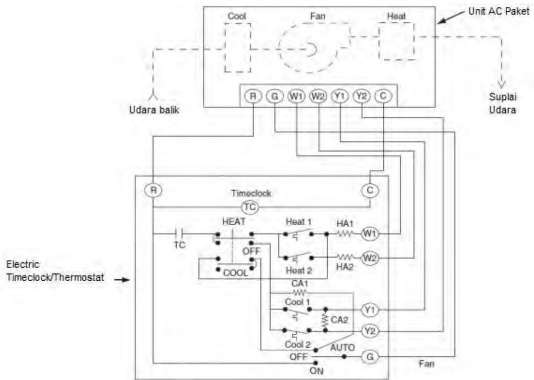
**Gambar 1.22 Unit Paket dengan Electric Control**
