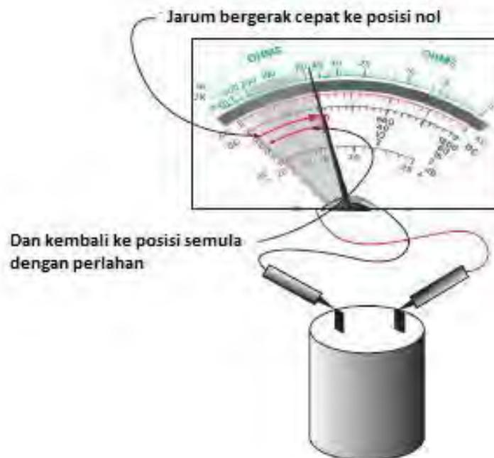
Gambar 5.6 Cara Memeriksa Kapasitor dengan Ohmmeter
