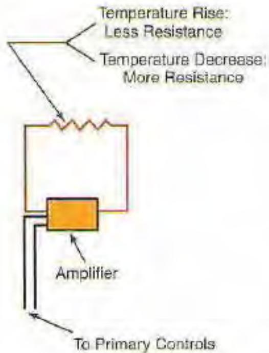
Gambar 3.4 Electrical Resistance: nilai resistansi berubah jika suhu berubah
