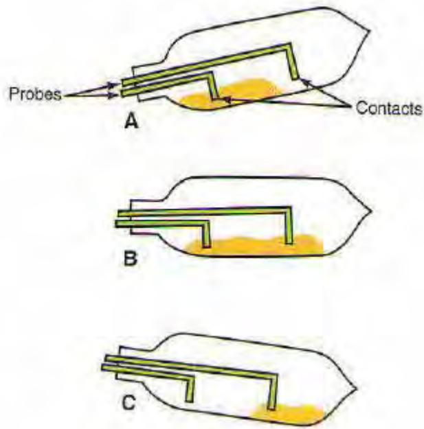
Gambar 3.7 Mercury Contact dengan SPST switch
