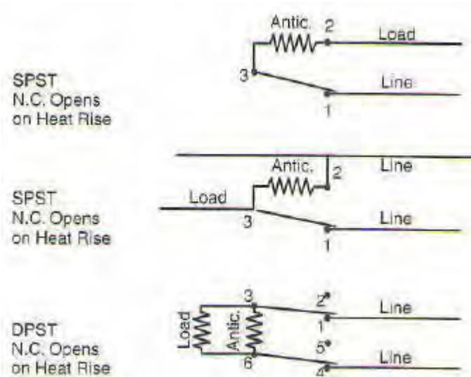
Gambar 3.11 Diagram Pengawatan Thermostat dengan Anticipator
