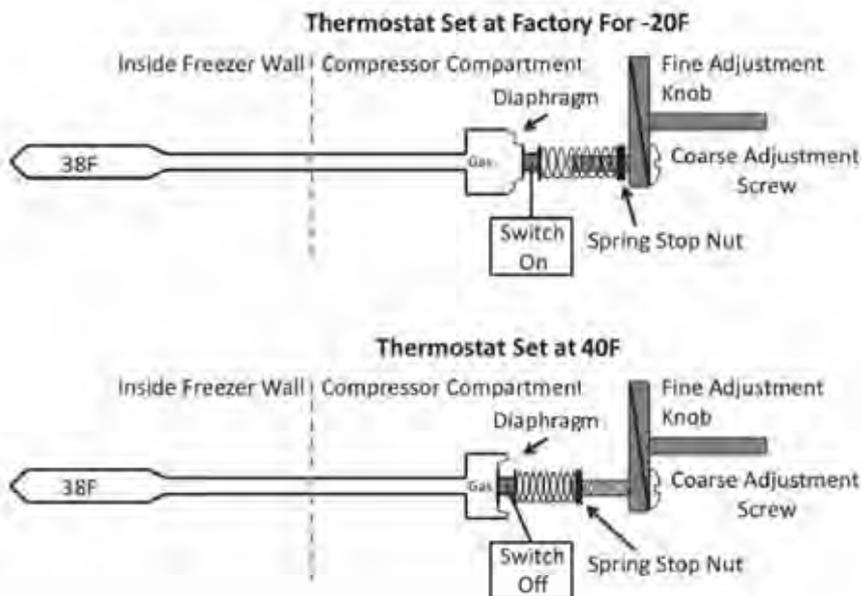
Gambar 4.3 Posisi On/OFF Elektromekanik Thermostat
