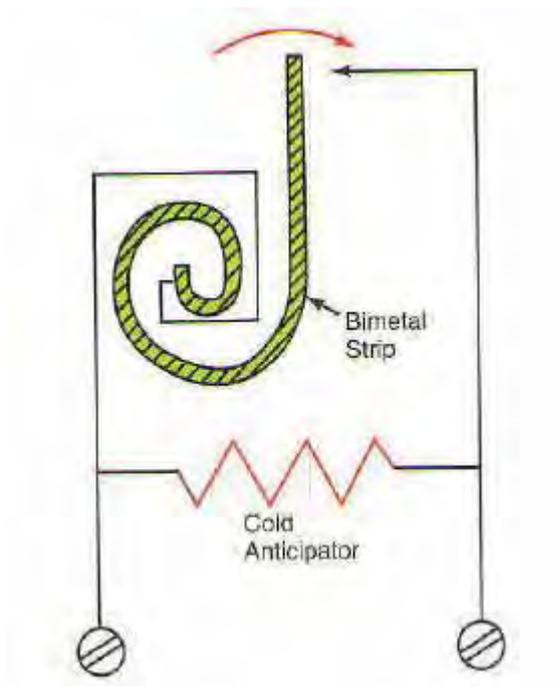
Gambar 3.13 Skematik Diagram Pengawatan Cooling Thermostat
