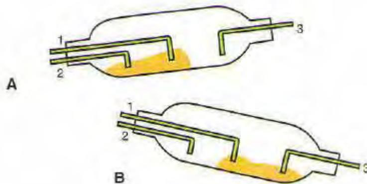
Gambar 3.8 Mercury Contact dengan SPDT Switch
