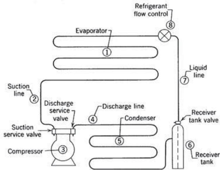
Gambar 5.16 Diagram Alir sistem Kompresi Gas
