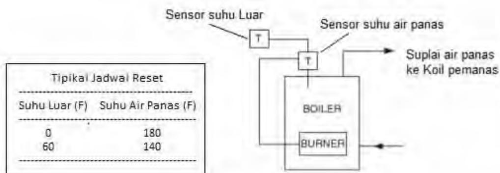
**Gambar 1.4 Sistem Pemanasan Ruang Sederhana dengan Boiler**
