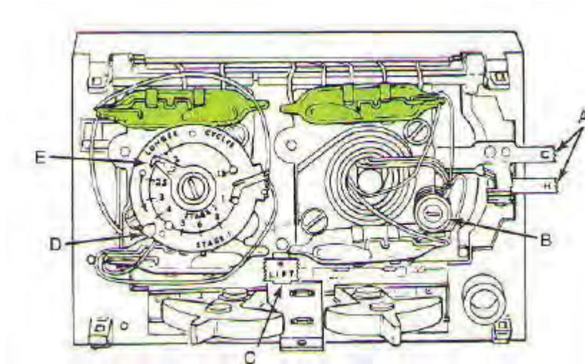
Gambar 3.10 Tipikal Staging Thermostat: untuk Cooling dan Heating Operation
