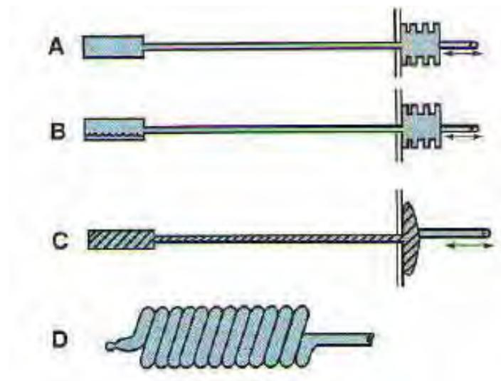
Gambar 2.1 Metoda mendapatkan efek gerakan pada perubahan suhu
