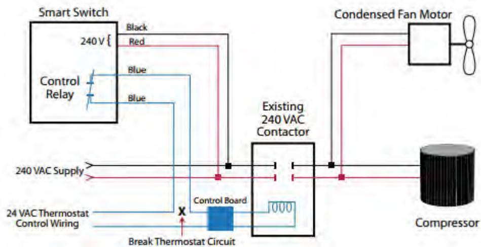
Gambar 4.19 Rangkaian Kontrol Kompresor Tidak Langsung
