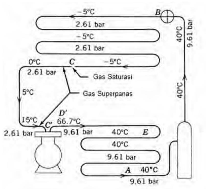
Gambar 5.17 Tipikal Proses Aktual Sistem Kompresi Gas
