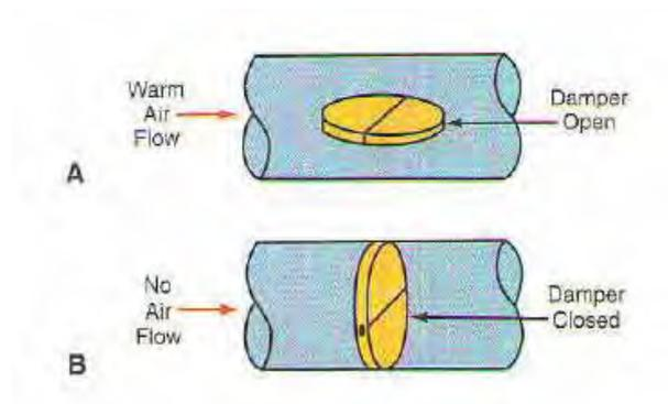
Gambar 1.6 Aksi Two-position on-off Control pada Damper Udara
