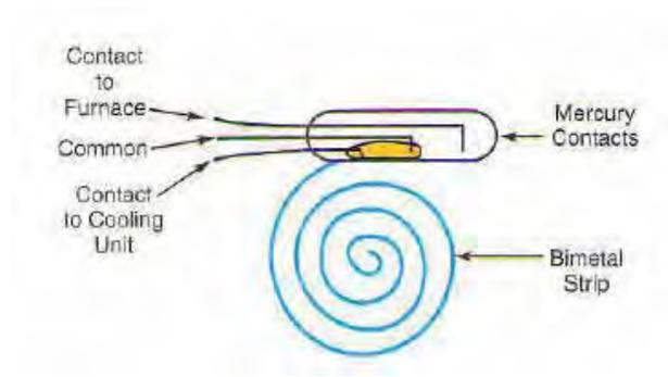
Gambar 2.7 Thermostat berbasis Mercury Bimetal
