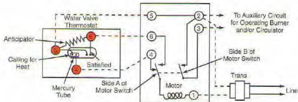
Gambar 3.9 Diagram Pengawatan Thermostat dengan Motor Penggerak Katub
