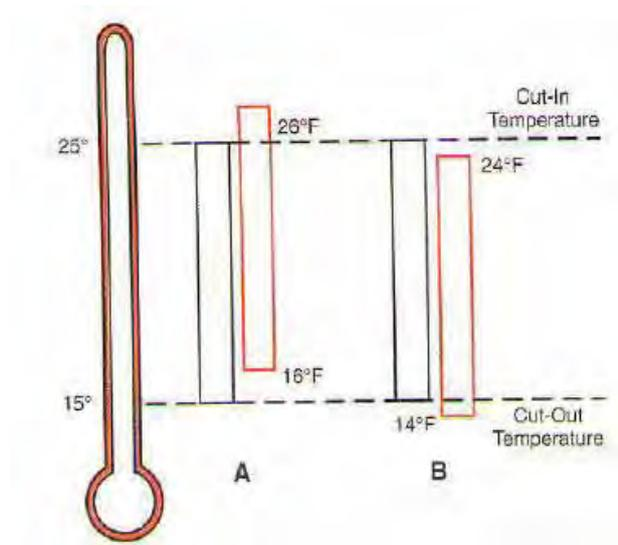
Gambar 2.13 Pengaturan Range Suhu Thermostat
