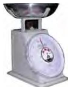
Gambar 1-9. Timbangan analog / manual
