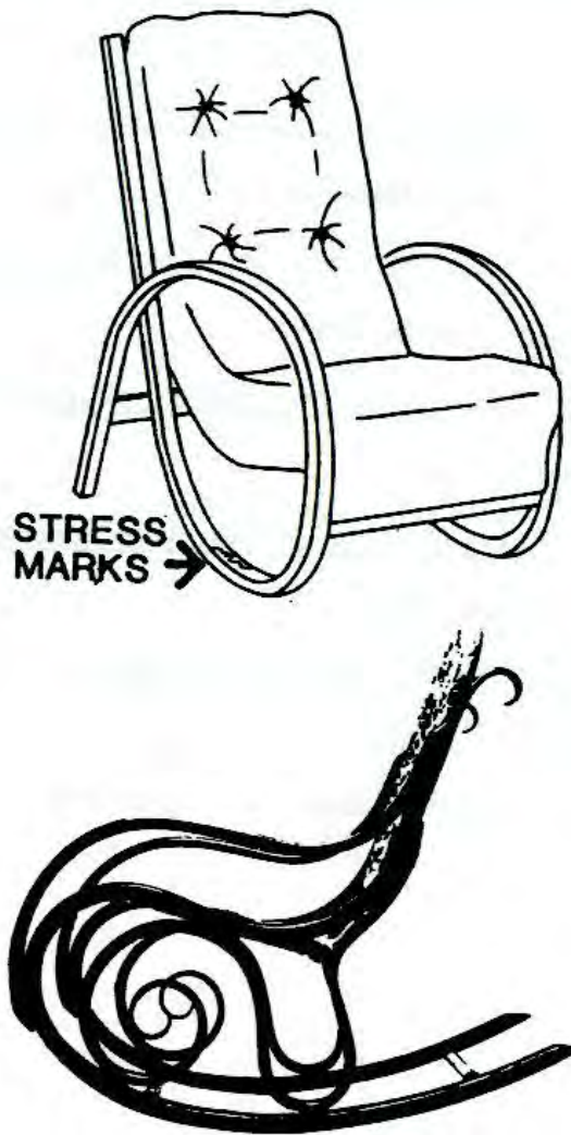
Gambar 23. Rocking chair dengan konstruksi lengkungan
