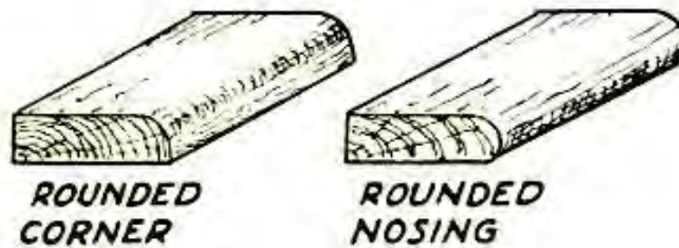
Gambar 2. Profil Rounded Corner bulat salahsatu sudut atau keduanya.
