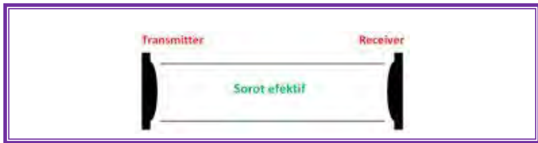
Gambar 4.102 Lebar efektif thru-beam
