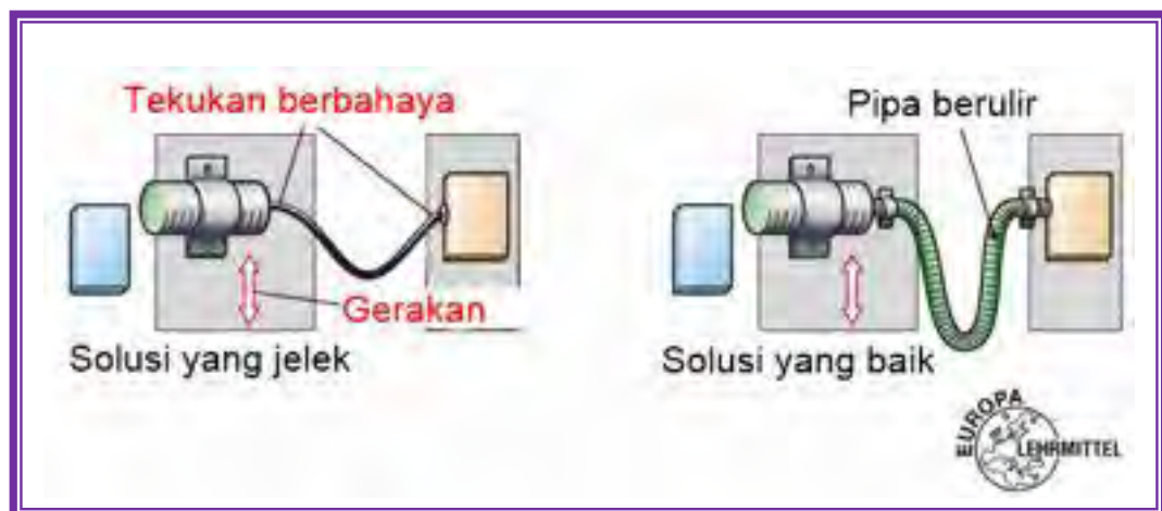
Gambar 4.47 Perakitan sensor bergerak
