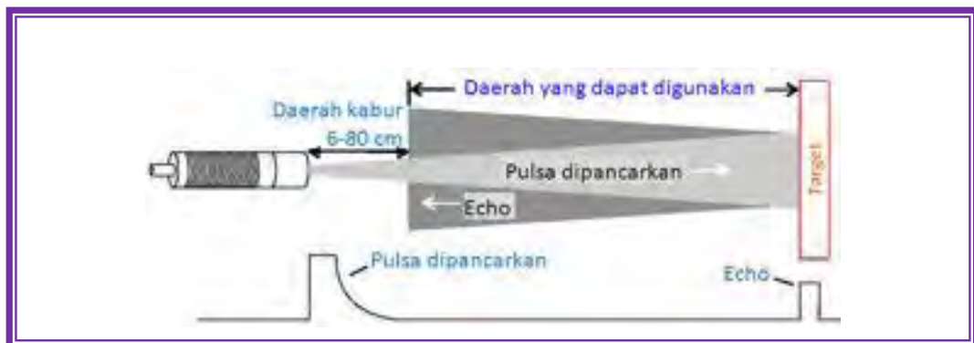
Gambar 4.73 Daerah kabur/buta/gelap sensor ultrasonik
