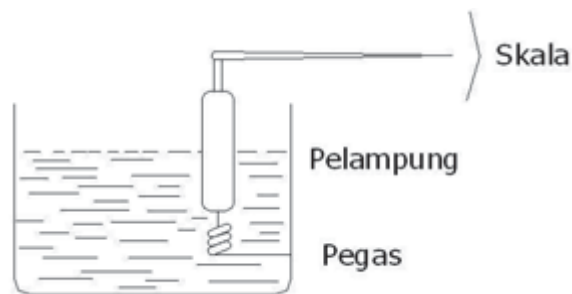
Gambar 3.12 :Levelmeter dengan simpangan pelampung
