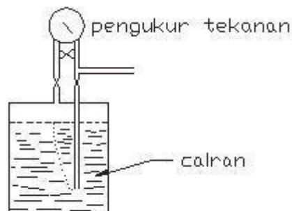
Gambar 3.33 : Gelembung udara pada tangki tertutup
