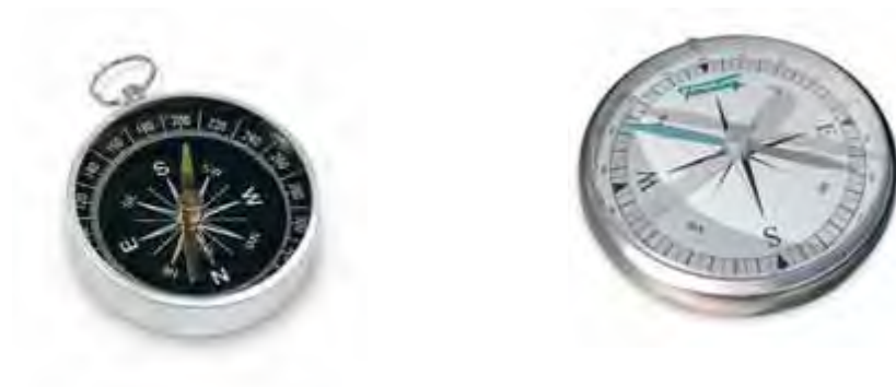
Gambar 1. Kompas sebagai penunjuk arah atau azimuth dalam pengukuran dan pemetaan tanah.
