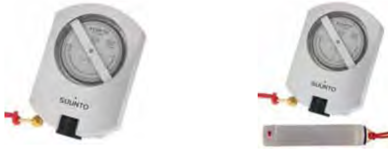
Gambar 2. Clinometer sebagai penunjuk teknis untuk mengetahui kelerengan/ kemiringan dalam pengukuran dan pemetaan tanah.
