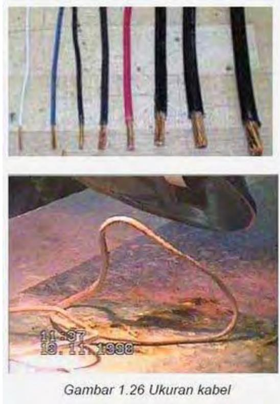
Agar terhindar dari peristiwa kapasitas lebih semacam ini maka ukuran kabel harus disesuaikan dengan peraturan instalasi listrik.
